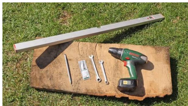
Für die Montage wird ein **Akkuschrauber** mit einem **4,2 mm Metallbohrer** sowie ein **Kreuzschlitzschraubendreher** (PH2) benötigt. Des Weiteren sind **Wasserwaage**, ein **Maßband** und ein **Stift** sowie zwei **10er Gabelschlüssel** erforderlich.
