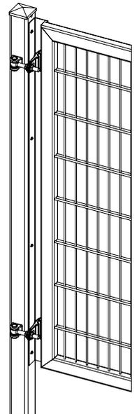
Die Bohrlöcher werden angezeichnet und anschließend mit  $\varnothing 4$  mm vorgebohrt. Anschließend wird die Spaltabdeckleiste mit den beiliegenden Bohrschrauben am Pfosten befestigt.
