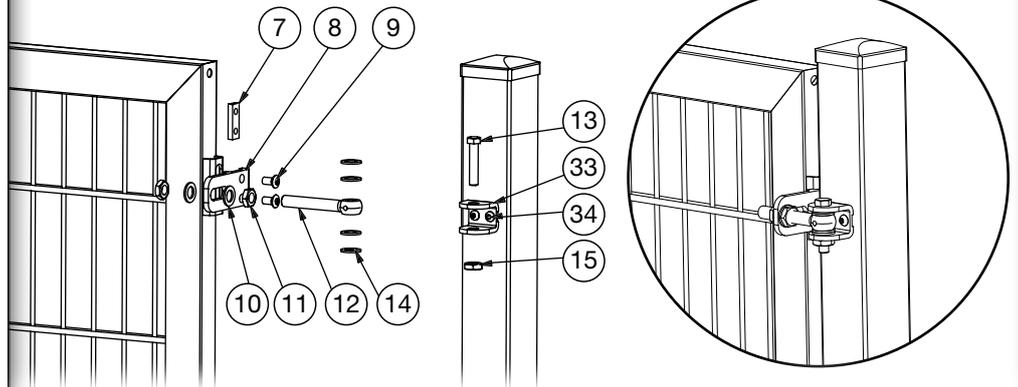
Die Scharnierlasche (8) mit Hilfe der Scharniergegenplatte (7) und der Scharnierlaschenschrauben (9) am Torflügel (1) befestigen. Die Augenschraube (12) mit Hilfe der Unterlegscheibe (14), dem Bolzen (13) und der Sechskantmutter (15) an der bereits angeschraubten U-Anschraublasche (33) am Scharnierpfosten (2) befestigen.
