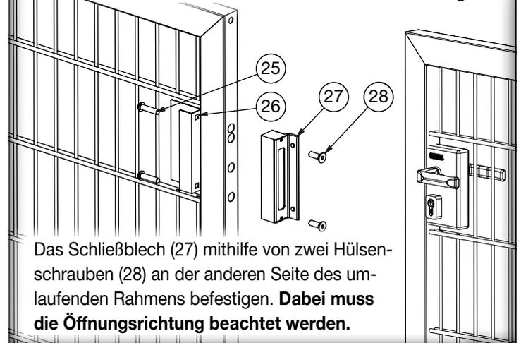
Das Schließblech (27) mithilfe von zwei Hülssenschrauben (28) an der anderen Seite des umlaufenden Rahmens befestigen. **Dabei muss die Öffnungsrichtung beachtet werden.**
