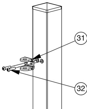
Die U-Anschraublasche (31) mit Hilfe der Rundkopfschrauben (32) anbringen.
