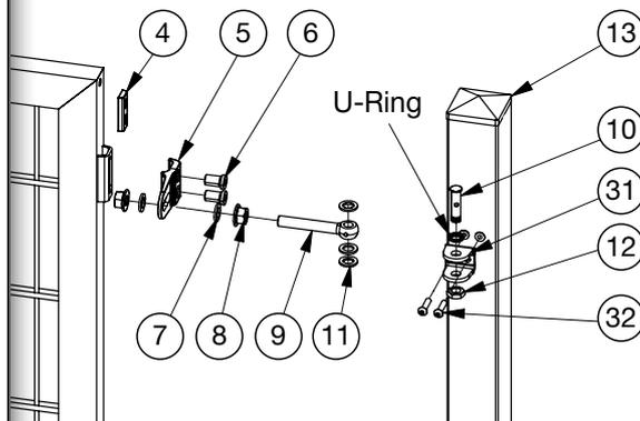
Die Scharnierlasche (5) mit Hilfe der Scharniergegenplatte (4) und der Scharnierlaschenschrauben (6) am Torflügel (1) befestigen. Die Augenschraube (9) mit Hilfe der Unterlegscheibe (11), dem Bolzen (10) und der Sechskantmutter (12) an der bereits angeschraubten U-Anschraublasche (31) am Scharnierpfosten (2) befestigen.
