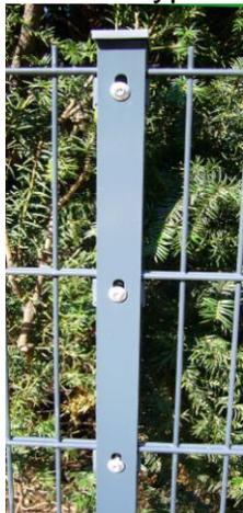
Bei der Verwendung des Pfostens Typ A sind alle 20 cm Befestigungspunkte vormontiert. Das Zaunelement wird bei der Montage auf die Kunststoff Gitterzaunklemmen aufgelegt, die Abdeckleiste vorgelegt und an den Halteklammern mit dem Sicherheits-Inbusschlüssel (5,5 mm) verschraubt.
